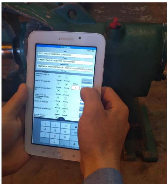
FIGURA 4 - Utilização de Tablet em Rotas de Manutenção
